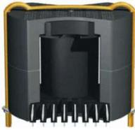
Kerne aus gepresstem Pulver, sogenannte „Ferritkerne“ verwendet man im Mittel- bis Hochfrequenzbereich ab etwa 20 kHz. Ferrite bestehen aus einer Mischung aus Eisenoxyd, Nickel, Zink- oder Manganoxiden und haben eine kristalline Struktur.
