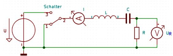
Der Kondensator sei zu Beginn des Versuchs entladen. Da es sich um eine reine Serienschaltung handelt, rechnen wir über den Strom  $i(t)$ , die Ausgangsspannung bekommen wir über das Ohmsche Gesetz dann gratis.
