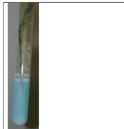
Abbildung 2: Oxidativer Angriff nitroser Gase an einem Kupferdraht in Anwesenheit von Luftfeuchtigkeit.
